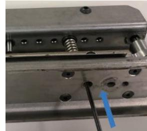
5. Faites glisser la nouvelle plaque de butée dans la gorge de la matrice et laissez-la tomber dans l'ouverture de la plaque de butée.
