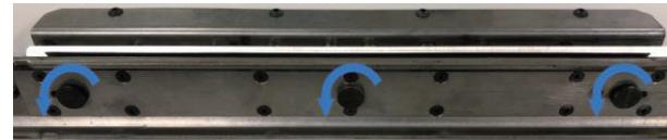
4. Retirez la plaque de butée de la gorge de la matrice. Si la plaque de butée ne sort pas facilement, la pousser par le bas en insérant un outil tel qu'une clé Allen, dans les trous prévus à cet effet, pour la libérer.
