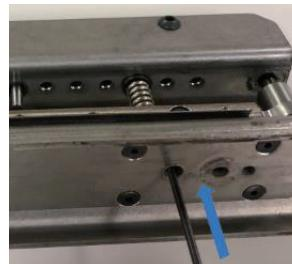
5. Schieben Sie die neue Gegenplatte in die Lochstempelkehle und lassen Sie sie in die Öffnung für die Gegenplatte rutschen.
