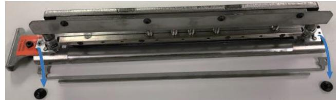
3. Tournez la matrice sur le côté et dévissez les 3 vis moletées de la face inférieure de la matrice.
