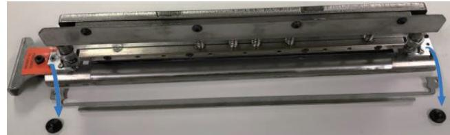
3. Legen Sie den Lochstempel auf die Seite und lösen Sie die drei Rändelschrauben auf der Unterseite des Lochstempels.
