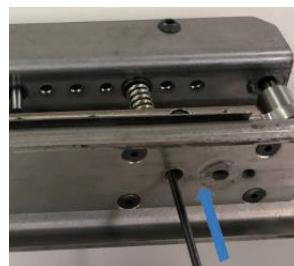
5. Deslice la nueva placa de soporte en la entrada del troquel y déjela caer en la abertura de la placa de soporte.
