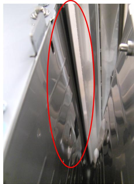
2. If the Lower entrance panel (PL #) is bent, Replace it (ARP #); If the Inner Entrance panel (PL #) is bent, Replace it (ARP #).
