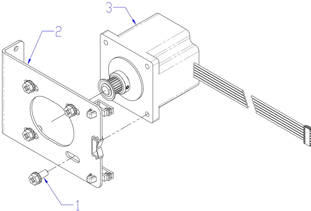
**PL 4.8. Punch Module- Punch Clutch**
