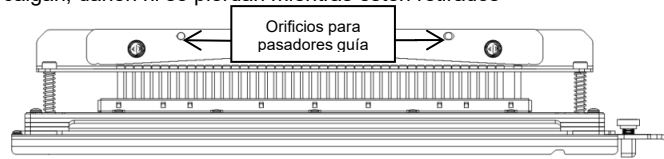
Figura 8.5 Reemplazo de la barra de presión
